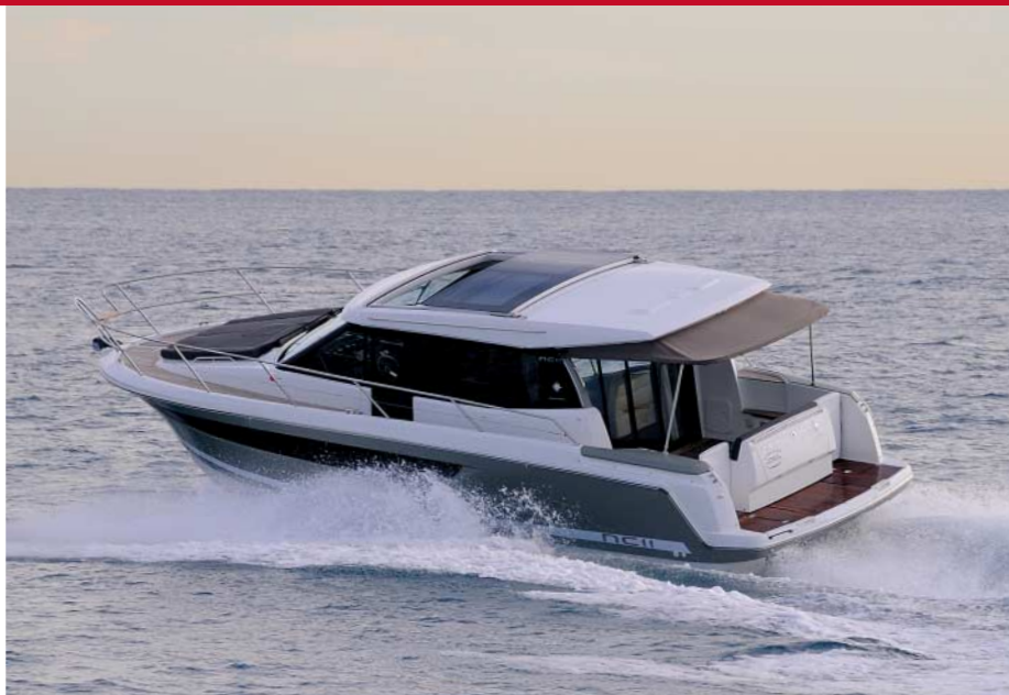
Tikovina na palubi je s popisa dodatne opreme, a osim lijevim, širim bočnim prolazom, na pramac se lako može i desnim; prostor u kokpitu može se povećati jednostavnim kliznim sustavom krmene klupe
